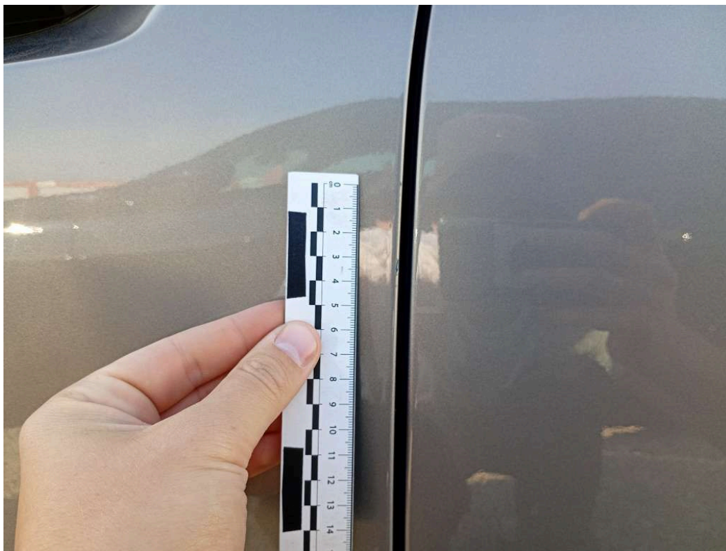
U3.2. Punktowy ubytek na drzwiach przednich lewych.
