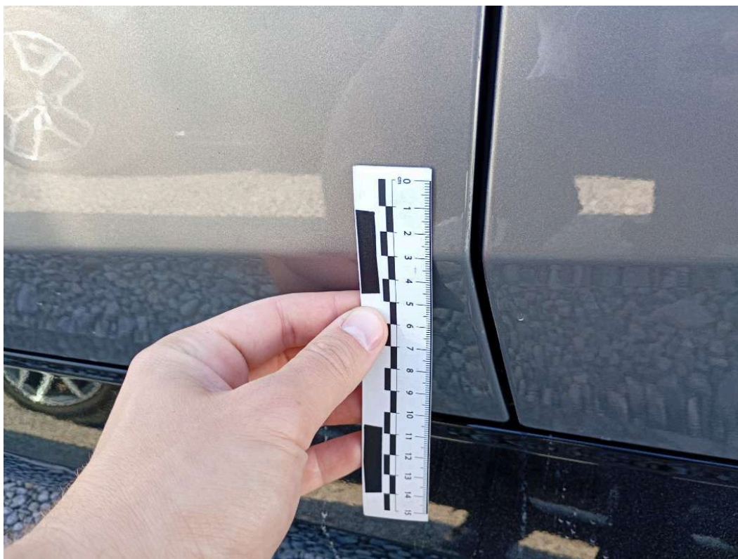
U3.1. Drobny ślad przy tylnej krawędzi drzwi przednich lewych.
