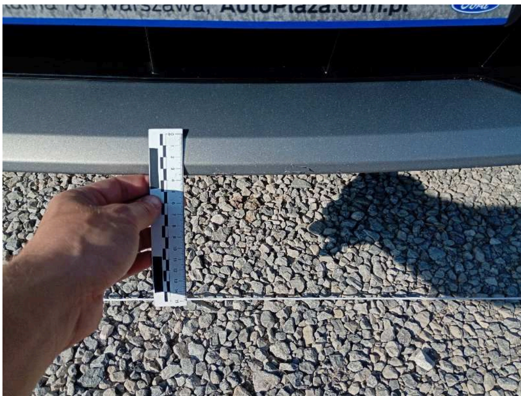
U1.3. Otarcie dolnej krawędzi zderzaka przedniego.
