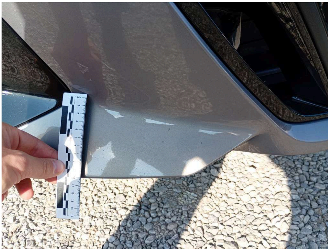
U1.1. Zarysowania dolnej części zderzaka przedniego.
