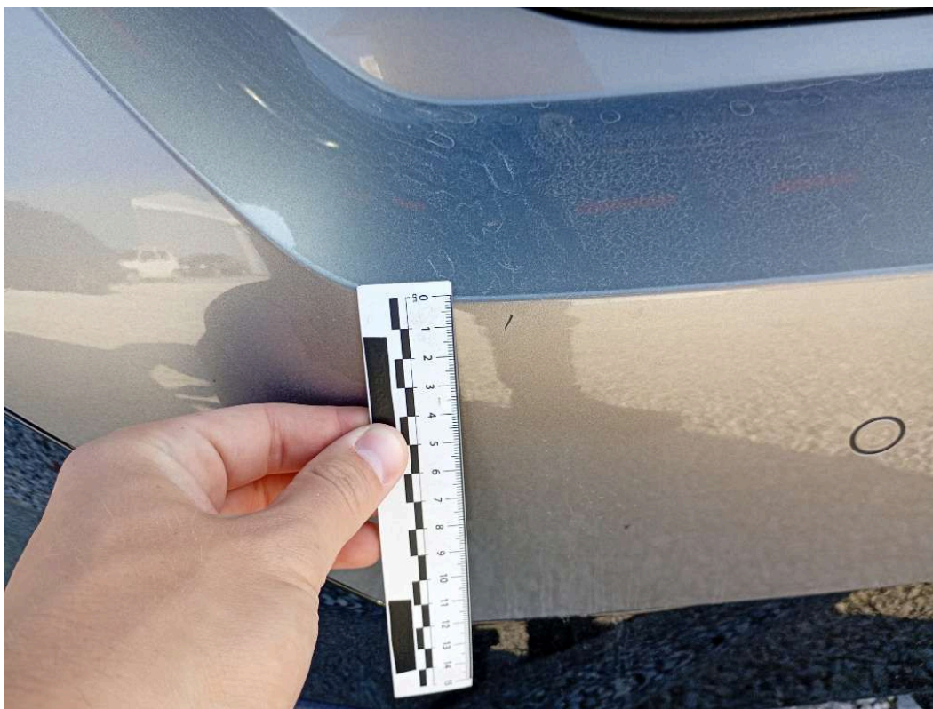
U4.1. Zarysowanie zderzaka tylnego.
