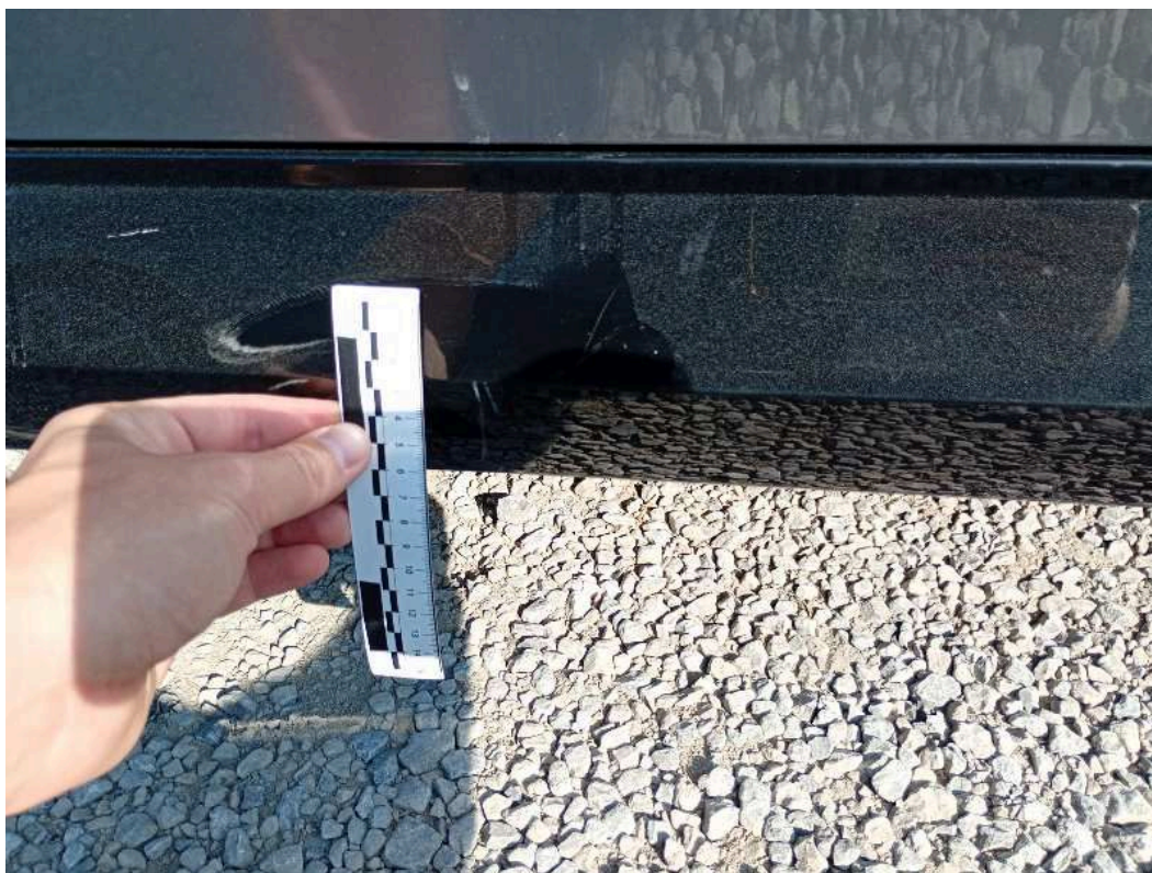
U8.2. Zarysowania listwy progu prawego.
