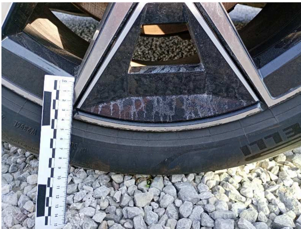
U5.2. Otarcie dolnej części rantu obręczy tylnej prawej.
