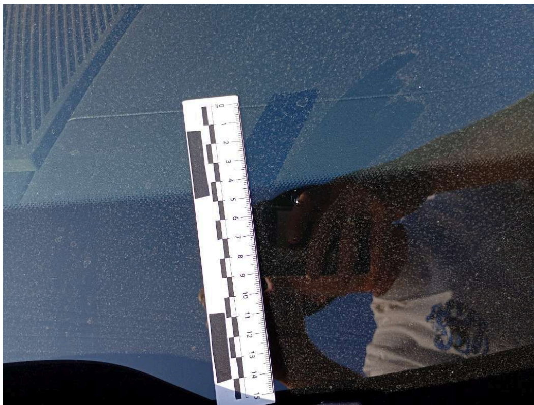
U2.2. Drugi punktowy odprysk szyby czołowej.
