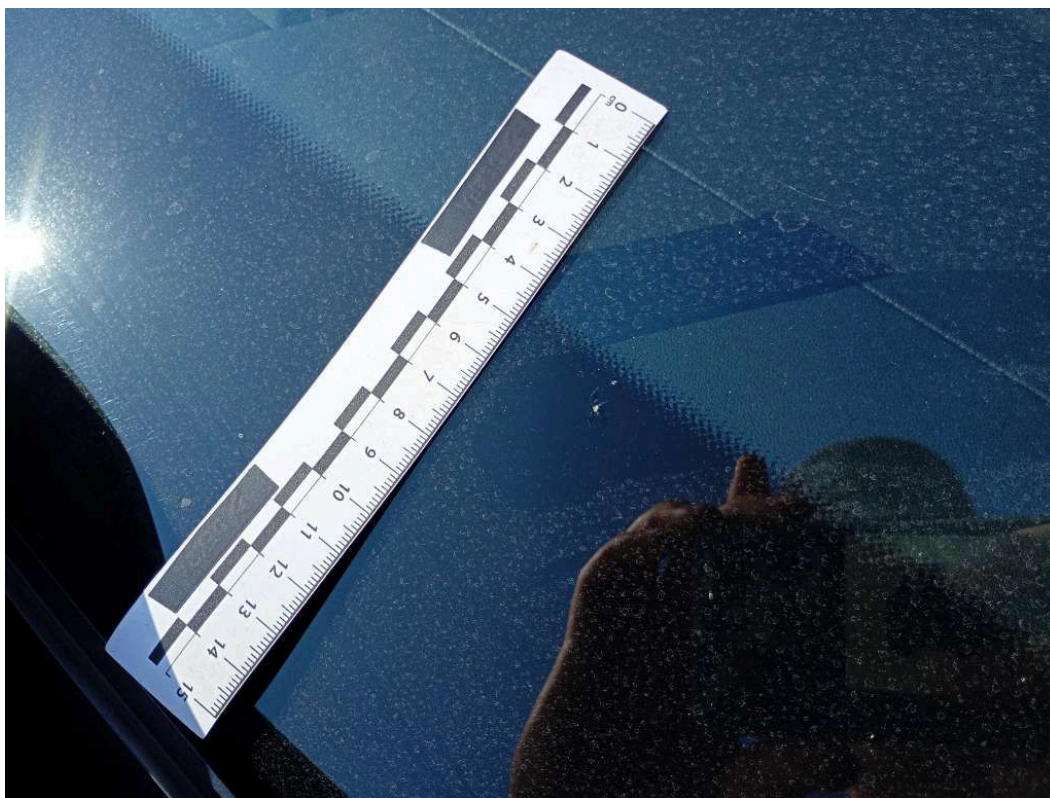
U2.1. Punktowy odprysk szyby czołowej.
