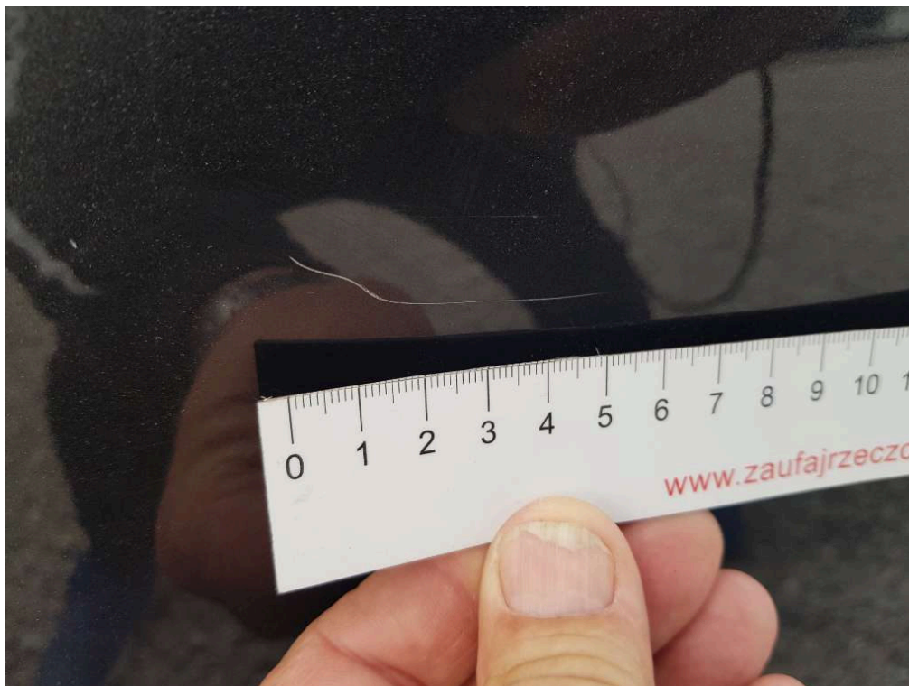
U1.1. Drzwi tylne prawe - zarysowanie z przymiarem.
