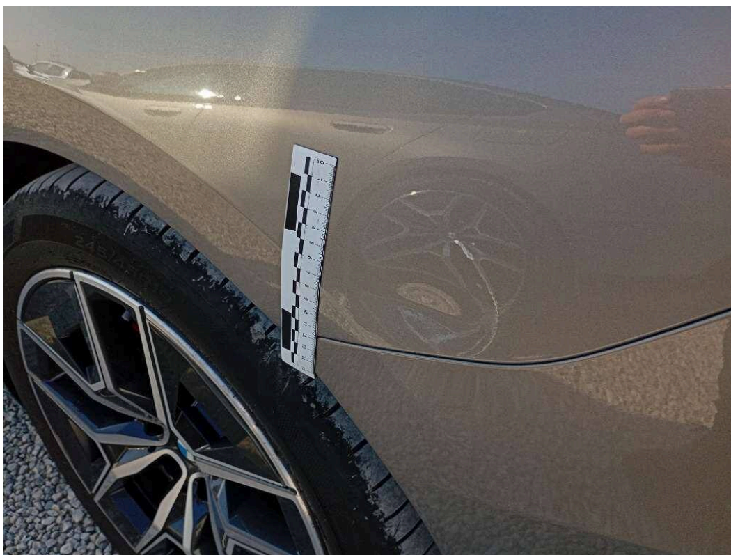
U2.1. Wgniecenie lewego tylnego błotnika - zbliżenie
