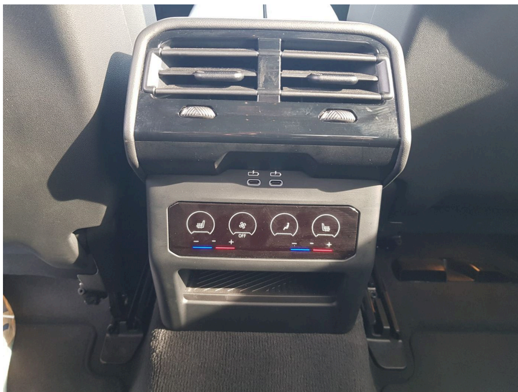
Z6. Tylny panel klimatyzacji i nawiewy
