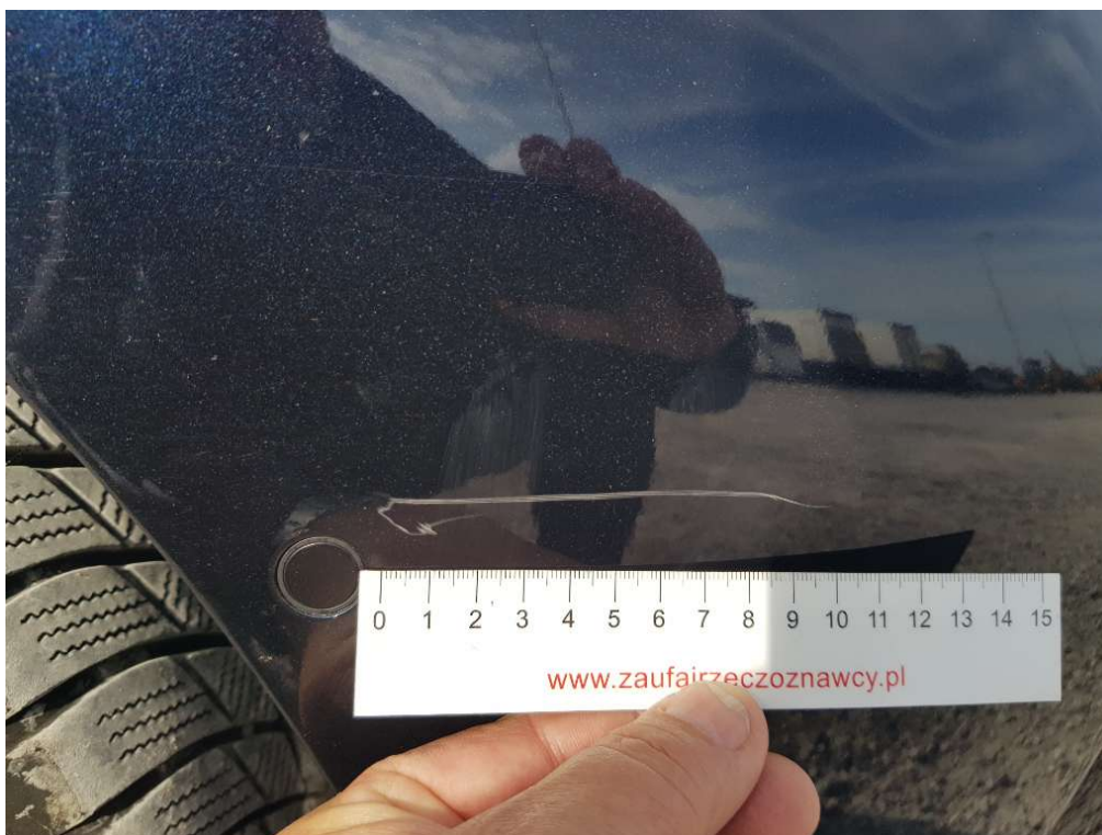
U1.1. Przedni zderzak, lewa strona - podłużne zarysowanie przy czujniku parkowania
