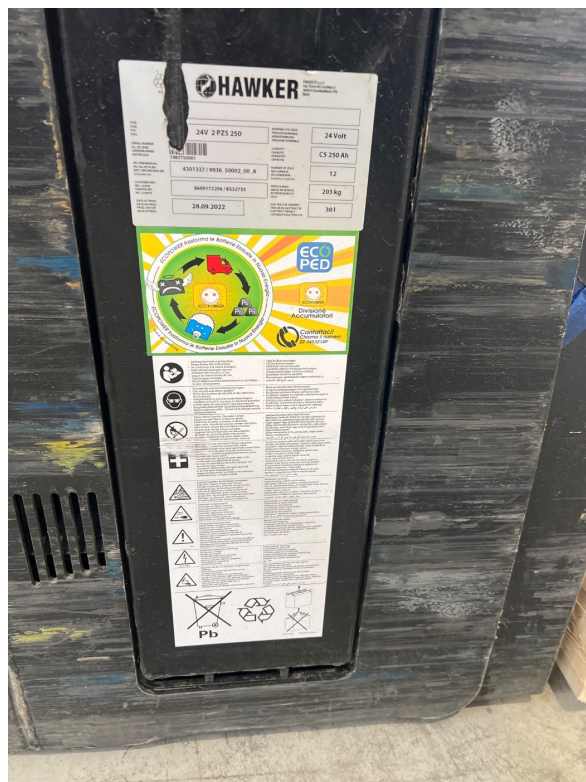
Fot. 7. Dodatkowa bateria Hawker: 24 V, 250 Ah, 203 kg; 28.09.2022.
