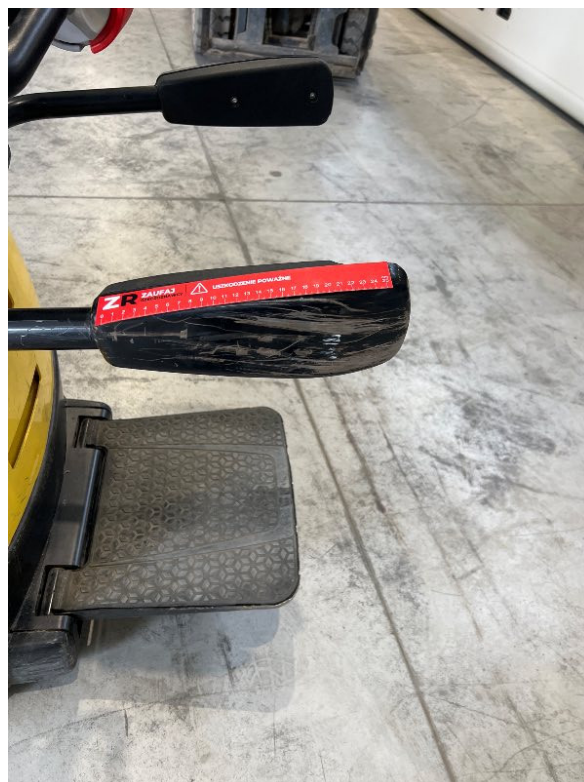
Fot. 4. Zarysowania drugiego bocznego pałaka ochronnego.
