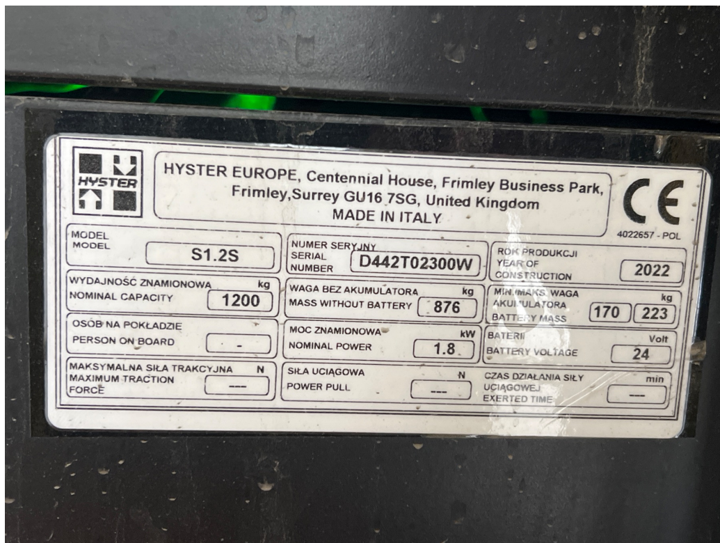
Fot. 5. Tabliczka: S1.2S, D442T02300W, 2022; masa bez baterii 876 kg.
