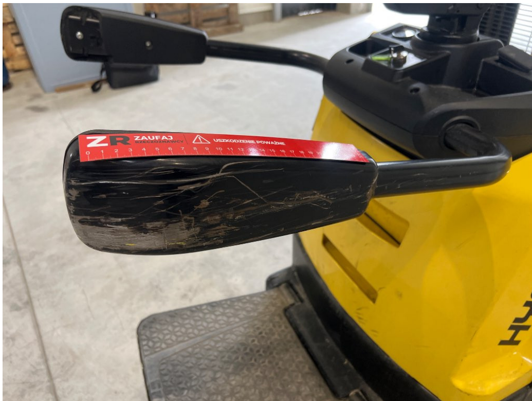
Fot. 3. Głębokie zarysowania bocznego pałaka ochronnego operatora.
