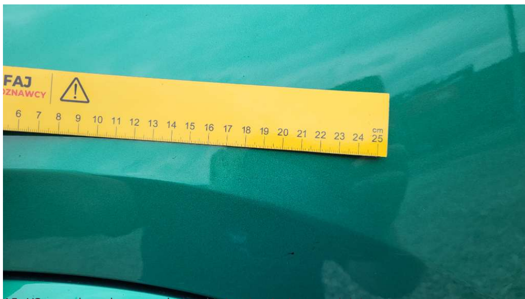
A5. U2 - wgniecenie prawych drzwi tylnych, ujęcie uzupełniające.
