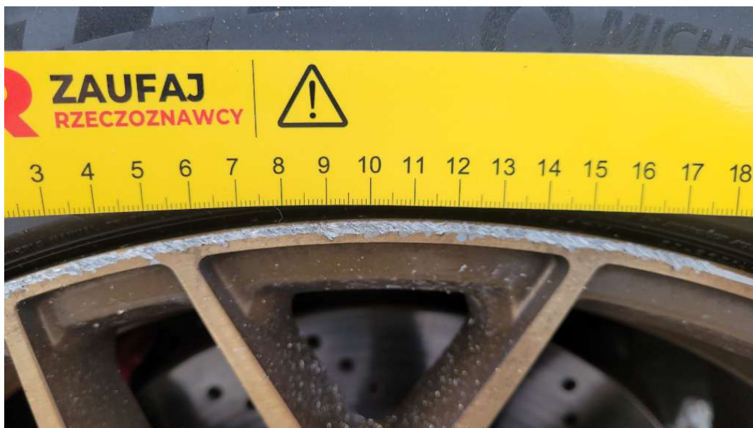
P1. U4 - obręcz przednia prawa, zarysowania po obwodzie.
