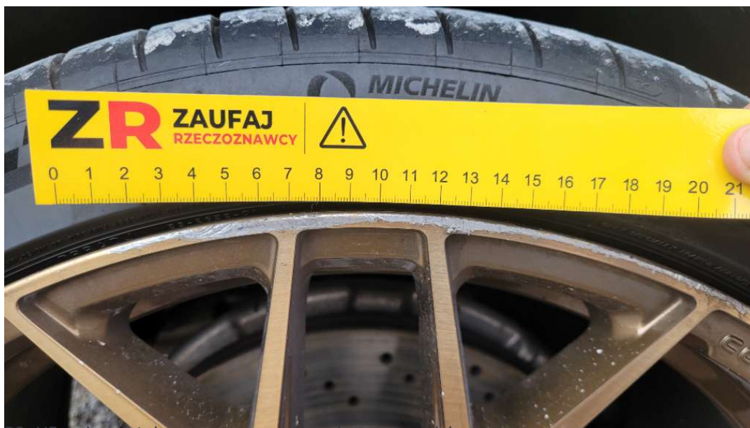
P8. U5 - obręcz tylna prawa, zarysowania po obwodzie.
