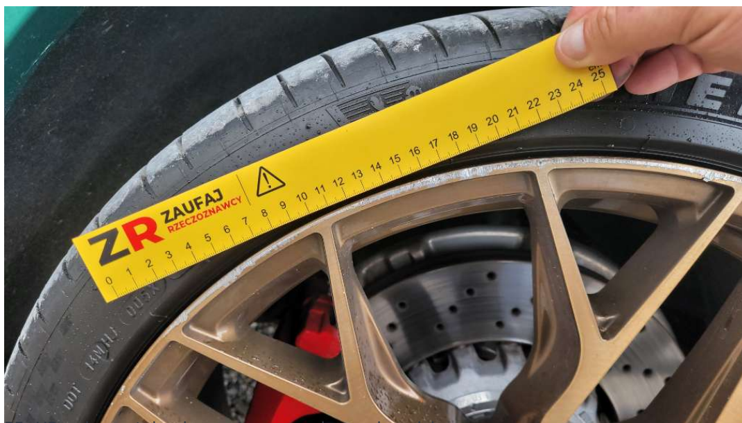
P5. U3 - obręcz tylna lewa, zarysowania po obwodzie.
